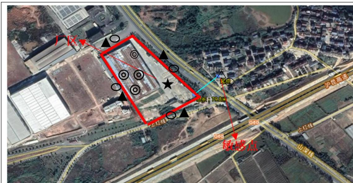
▲噪声检测点 ○无组织检测点（敏感点）◎有组织废气监测点 ★废水监测点 △敏感点声环境点
