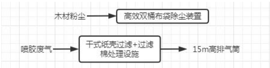
图 3-2 废气处理工艺流程图
